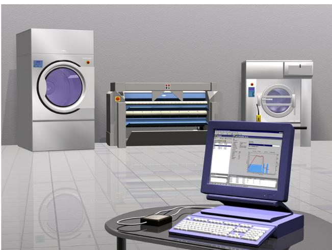
CMIS kann an Waschmaschinen mit Clarus Control, Trommelrockner mit Selecta Control und Bügelmaschinen mit elektronischem Steuersystem angeschlossen werden. Man benötigt lediglich einen normalen PC, um die Statistikfunktionen nutzen zu können.
